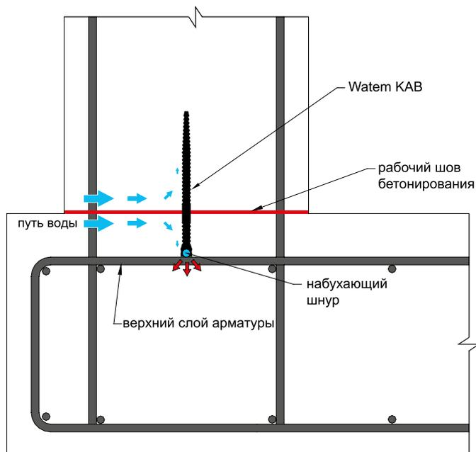
Гидрошпонка поставляется в комплекте с фиксатором, изготавливаемым из стальной проволоки d4 мм из расчёта 3 ед. на м. п. или из рифлёной арматуры d6 мм из расчёта 2 ед. на м. п. По вашему запросу гидрошпонка тип КАВ может комплектоваться (за дополнительную плату) защитным резиновым кожухом, предохраняющим шнур от преждевременного набухания до окончательной укладки изделия.
